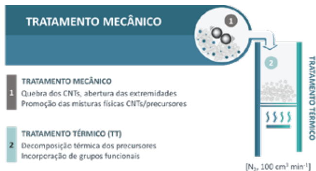
Fig.1. Ilustração esquemática da metodologia mecanotérmica para a incorporação de heteroátomos em nanotubos de carbono.
